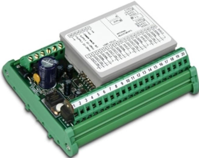
Transmetteur de poids analogique avec sortie courant à sélectionner : 0-20 mA, 4-20 mA, 0-10 mA ou tension : +/-5 Vdc. Conçu pour être installée en montage fond d'armoire sur barre DIN. Cartes analogiques/digitales à 12 bits installées sur PLC.
