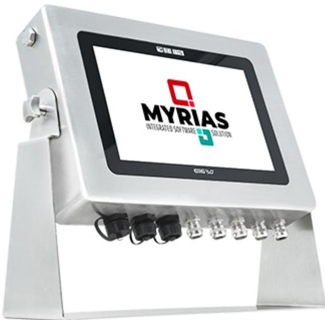
Nouveau PC industriel à écran tactile avec un boîtier en acier inoxydable AISI 304 et un degré de protection IP67, spécialement conçu pour les environnements industriels difficiles. Il permet le chargement de n'importe quel programme de pesage développé sous Windows 10, pour la création de systèmes de pesage avancés. Processeur Intel haute performance et jusqu'à 4 entrées de balance.
