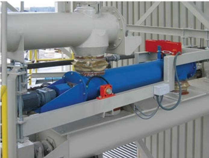
En dotant un convoyeur à vis nouveau ou existant d'un système de pesage à vis, il est possible de facilement créer une mesure en ligne sans perturber le flux de produits.
