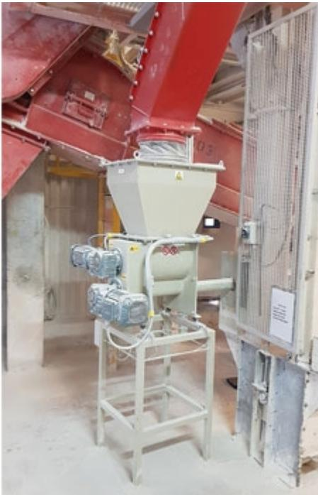
Les doseurs à perte de masse surveillent le poids au fil du temps et calculent le flux de matériaux. Une boucle de contrôle PID est utilisée pour réguler le flux de matériaux à mesure de sa distribution. Le produit peut ensuite être transporté par un convoyeur à vis, un convoyeur vibrant, une bande transporteuse ou autres. Rice Lake peut fournir soit la balance seule, soit le système complet avec convoyeur doseur.
