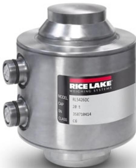
Capteur compression numeriques pour les ponts bascules approuvées CE-M, les réservoirs, les silos et les témies. En acier inox, avec un degré d'étanchéité IP68, 6000 divisions.
