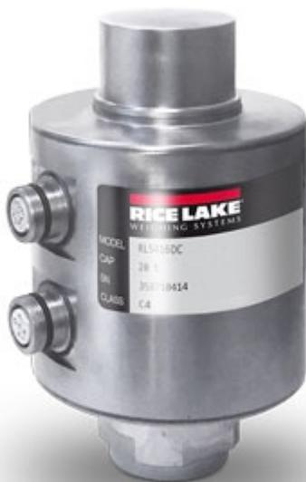
Capteur compression numeriques pour les ponts bascules approuvées CE-M, les réservoirs, les silos et les témiees. En acier inox, avec un degré d'étanchéité IP68, 4000 divisions.
