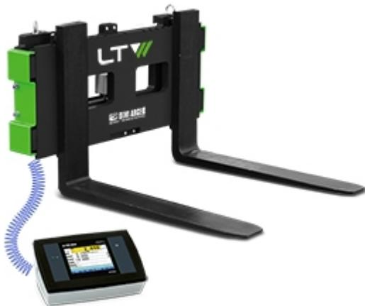
Tablier peseur pour chariot élévateur avec guide de fixation DIN15173 - FEM classe II, pour transformer un chariot élévateur normal en une balance mobile. Equipé d'un indicateur de poids à écran tactile dans la cabine pour des applications avancées. Disponible également en version homologuée pour un usage réglementé.
