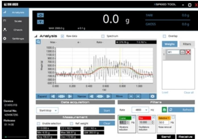
Logiciel pour PC qui permet d'enregistrer en temps réel le signal provenant du capteur et de le traiter en appliquant des filtres spécifiques pour éliminer les vibrations, le bruit et les perturbations. Indispensable pour obtenir des pesées précises et rapides dans les systèmes de pesage automatisés.
