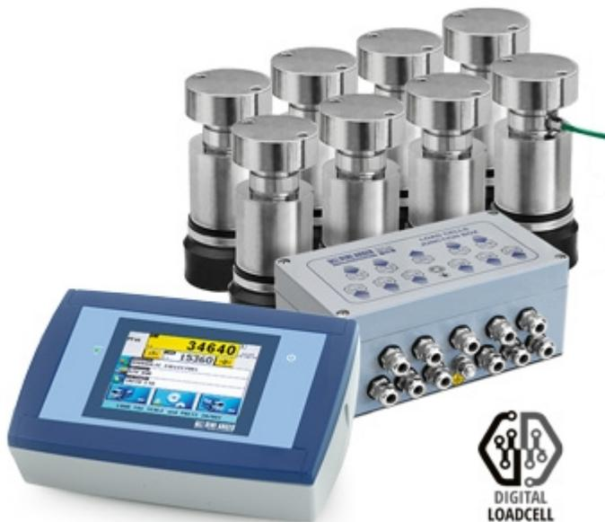
Cette chaîne de mesure pour ponts bascules numérique est composée d'un indicateur de poids 3590ETD avec écran tactile et logiciel AF03 pour ponts bascules, 8 capteurs numériques "RCPTD" en acier inox IP68, complets de plaques oscillantes en acier galvanisé et d'une boîte d'égalisation numérique avec diodes de protection.
