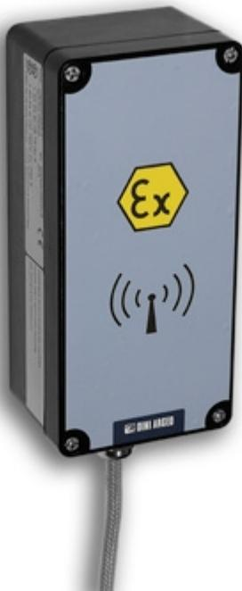
Module WIFI pour la communication SANS FIL des données en zone ATEX 2 et 22, aux normes : ATEX II 3G Ex ec IIB T6 Gc X pour gaz ATEX II 3D Ex tc IIIC T85°C Dc IP66 X pour poudre.
