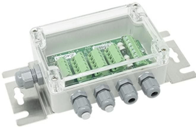
Boîte de jonction avec protection IP67 à 4 entrées spécifiques pour les milieux extérieurs. Elle peut être utilisée comme boîte d'égalisation ou de jonction simple de 2, 3 ou 4 capteurs. Borniers à vis pour faciliter la connexion et trimmer de réglage du signal, pour une égalisation précise et fiable. Le circuit de protection protège contre les foudres et les surtensions.
