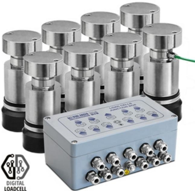
Cette chaîne de mesure pour ponts bascules est composée de 8 capteurs numériques série RCPTD en acier inox IP68, des plaques oscillantes en acier galvanisé et d'une boîte de jonction avec 10 entrées (disponible pour l'indicateur 3590E ÉCRAN TACTILE).
