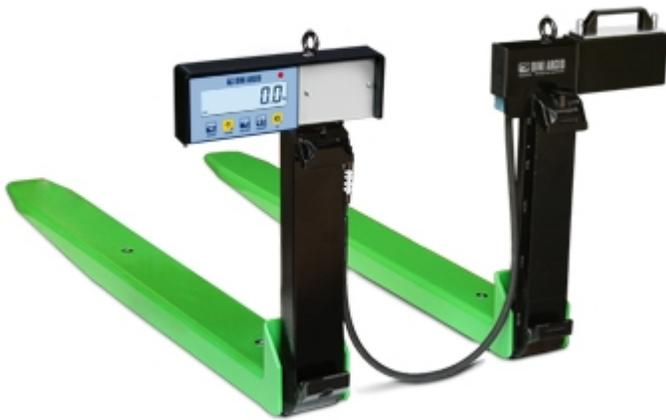
Fourches peseuses pour chariot élévateur, robustes, fiables et facile à installer . L'indicateur en option à monter en cabine, en liaison sans fils avec les fourches, facilite les opérations et dispose d'une vaste gamme d'accessoires. Fonctionnement par batterie rechargeable et alimentation directe depuis le chariot. Compatibles avec tout chariot ayant la plaque porte fourche type DIN 15173 - FEM, classe IIA (IIB en option) ou IIIA. Disponibles en version homologuée CE-M.
