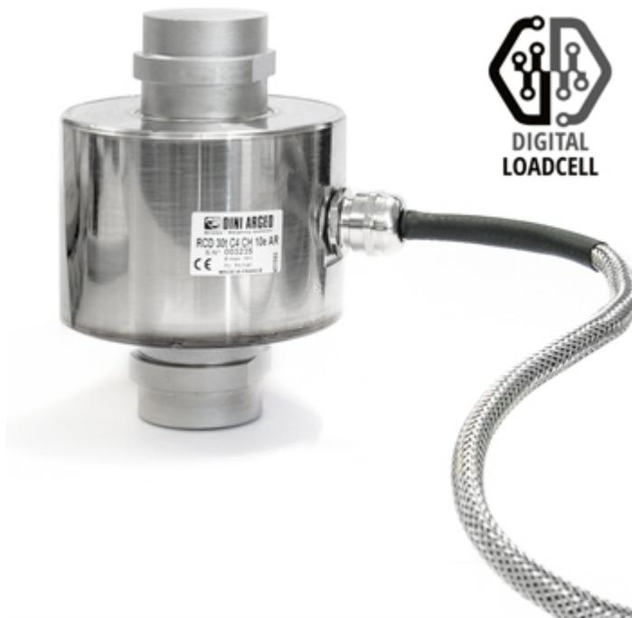
Capteur compression numeriques pour les ponts bascules approuvées CE-M, les réservoirs, les silos et les témiees. En acier inox, avec un degré d'étanchéité IP68, 4000 divisions, câble blindé "contre les rongeurs" de série.
