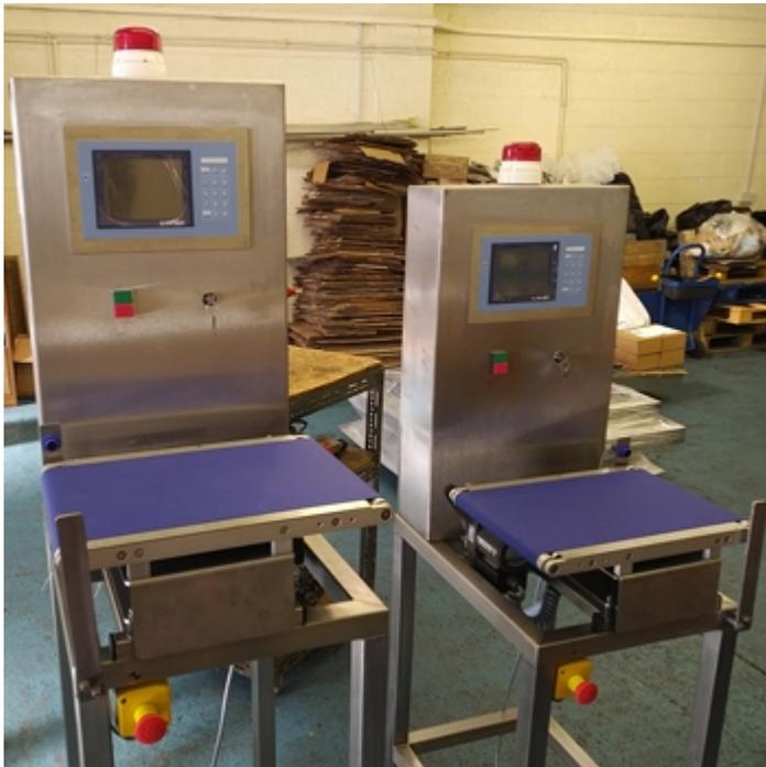
Exemples et installations de système de pesage sur bande pour le contrôle du poids
