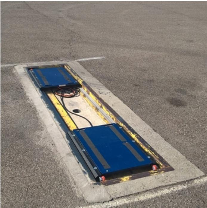
Exemples et installations de plate-formes pèse essieux et roues portables
