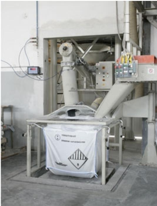
Exemples d'installations et machines pour remplissage de big-bag
