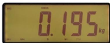
La couleur du rétro-éclairage, dans le fonctionnement du contrôle de tolérance, change automatiquement en fonction du poids.
