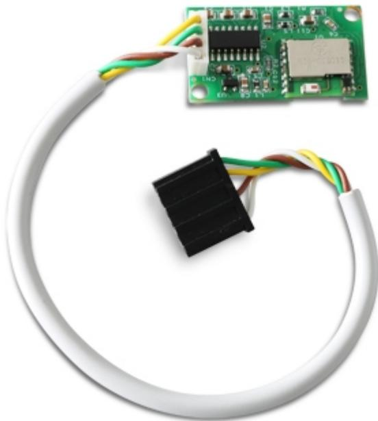
Grace à l'interface Bluetooth, intégrable à l'intérieur de l'indicateur de poids, l'échange de données entre le PC portable ou le PC de poche et l'indicateur de poids sera plus facile et rapide. Il suffit de se déplacer quelque mètres de l'indicateur de poids pour mettre à jour les archives, lire la mémoire, envoyer des commandes, recevoir des données, contrôler la configuration etc.
