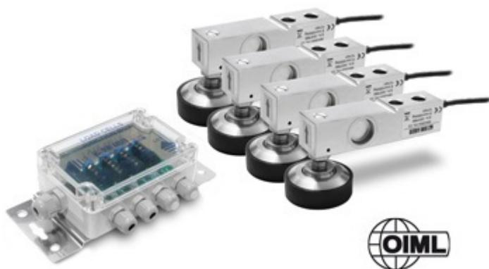
Kit étudié pour réaliser des plateformes à 4 capteurs en différentes dimensions et capacités. Le kit est composé de 4 capteurs de 350 Ohm, homologués OIML, en acier inox IP68, avec pieds rotulés en acier inox et boîte d'egalisation en ABS IP67.
