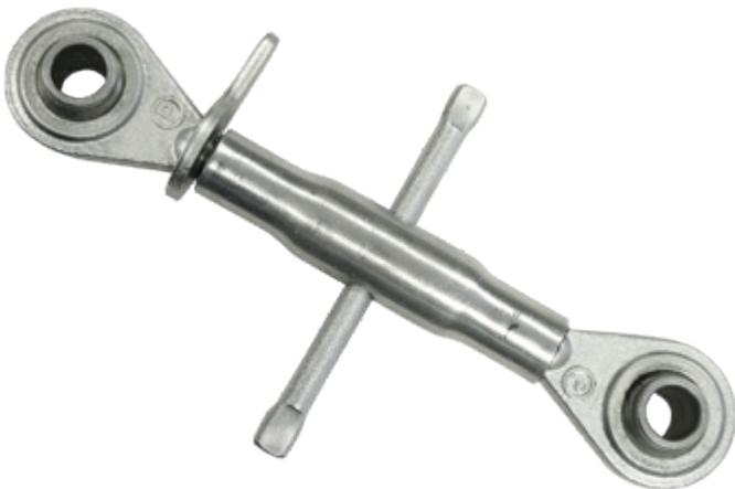
Tendeur en acier à utiliser pour reguler les mouvements de la structure à peser sans perturber la precision de pesage. Equipé par deux articulations rotulés, longueur total réglable de 260 à 350mm.
