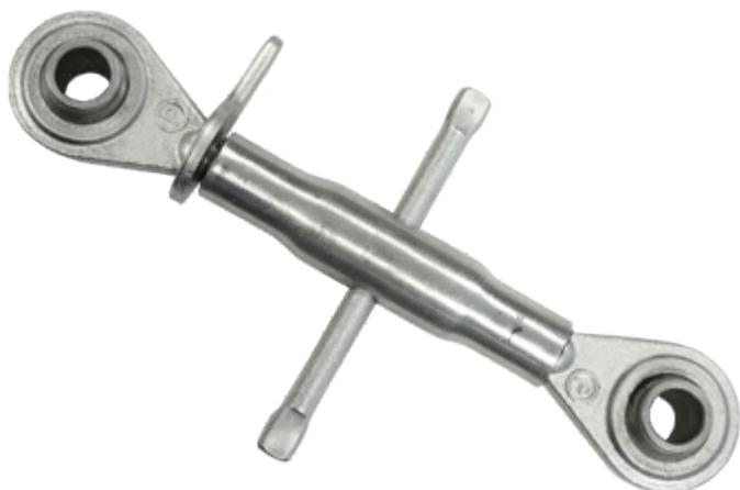
Tendeur en acier à utiliser pour réguler les mouvements de la structure à peser sans perturber la précision de pesage. Equipé par deux articulations rotulés, longueur total réglable de 260 à 350mm.
