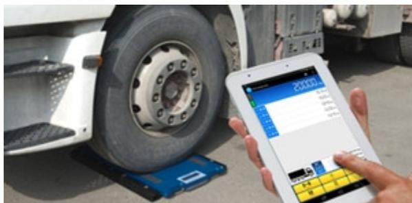
L'exemple vous montre une application avec une WWS. Une WWS RF, option WWSDUAL, option Bluetooth et Tablet avec APP "Dini Smart AXLE".
