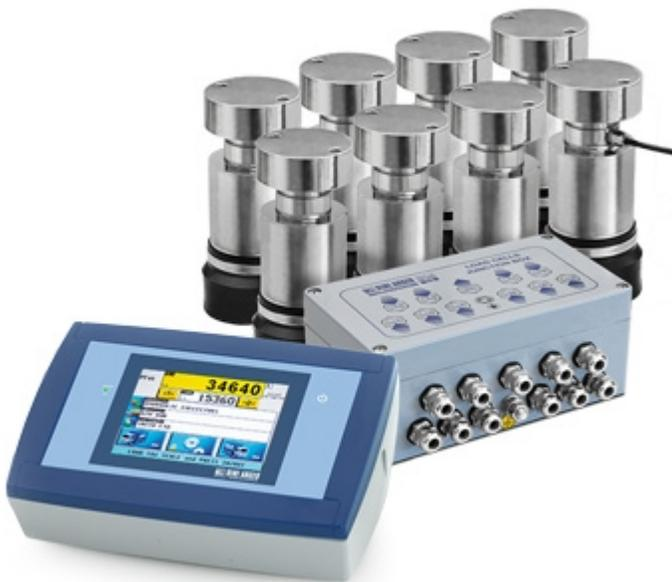
Cette chaîne de mesure pour ponts bascules analogique est composée d'un indicateur de poids 3590ET avec écran tactile et logiciel AF03 pour pont bascule, 8 capteurs analogiques "RCPT" en acier inox IP68, complets de plaques oscillantes en acier galvanisé et de la boîte d'égalisation avec diodes de protection.
