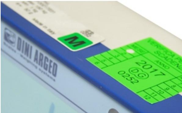
Service de Vérification Primitive commandé simultanément avec l'instrument nouveau (balances de comptoir, plateformes de pesage, plateformes pèse roues, crochets peseurs, etc.), selon la norme EN 45501.
