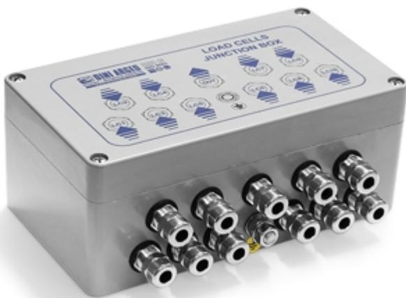
Boîte de jonction à 10 entrées, équipée d'une carte électronique pour la jonction et l'égalisation de jusqu'à 10 capteurs. Particulièrement adaptée pour les ponts bascules, avec les diodes contre les décharges et les perturbations électriques. Boîtier idéal pour les environnements difficiles, avec presse-étoupes en métal et prise de terre. Borniers à vis pour faciliter la liaison des capteurs et le réglage du signal, pour une égalisation précise et fiable.
