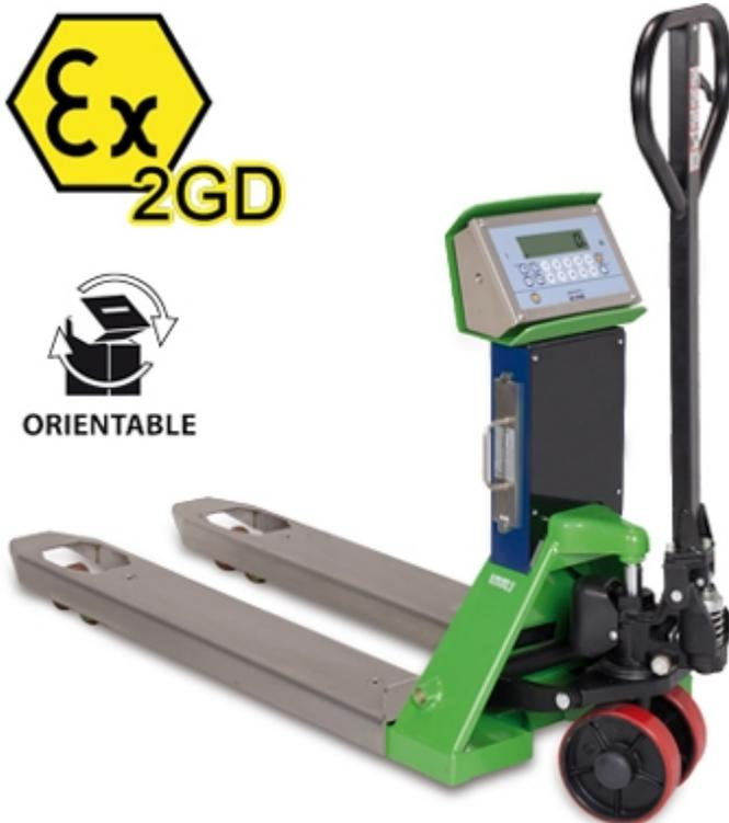
Transpalette manuel avec électronique de pesage pour zones dangereuses. Zones classées à risques d'explosions (ZONES 1 et 21 & 2 et 22) selon les normes ATEX Ex II 2G IIB T4 Gb X et Ex II 2D IIIC T197°C Db X. Equipé de 4 capteurs ATEX en acier INOX étanches IP68, garantissant une précision dans toutes les conditions de travail. Fabriqué, calibré et étalonné en Italie par Dini Argeo, en utilisant des poids-étalons certifiés. Disponible également en UR pour la transaction commerciale CE-M.
