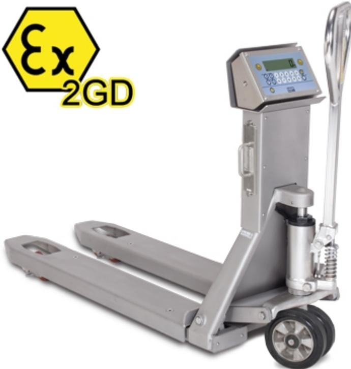
Transpalette manuel avec électronique de pesage pour zones dangereuses classées à risques d'explosions (ZONES 1 et 21 & 2 et 22) selon les normes ATEX Ex II 2GD IIB T4 T197°C X. Equipé de 4 capteurs ATEX en acier INOX étanches IP68, garantissant une précision dans toutes les conditions de travail. Structure entièrement en acier inoxydable. Disponible également en UR pour la transaction commerciale CE-M.
